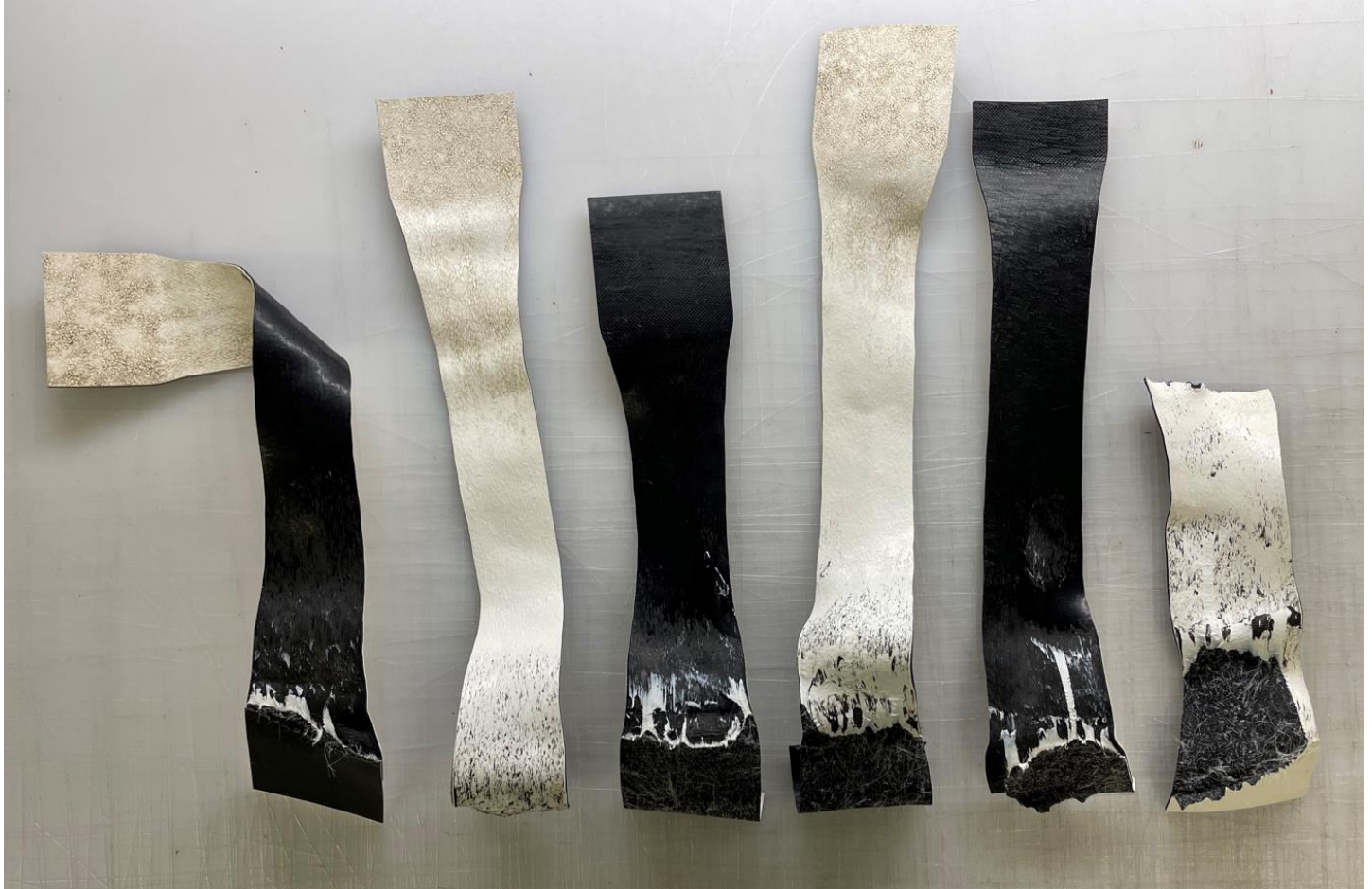
Figura 4: Immagini delle saldature del campione MAPEPLAN T B 15 prelevato dal cantiere dopo prova di trazione a peeling
