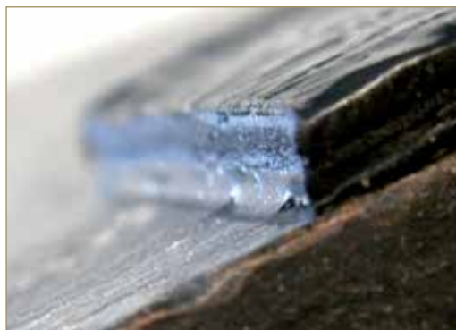
TEST DI RESISTENZA ALLO SCORRIMENTO A CALDO UNI 8202 Parte 16
