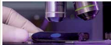
SPESSORE - Microscopio fluorescenza ingrandimento 250X. Normativa UNI EN 1849-1
